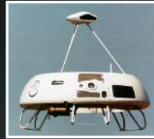
طبق طائر غير مجهول: المركبة Cypher التي صنعتها الشركة الأمريكية Sikorsky و هي بلا طيار و تعلق بشكل عمودي.
