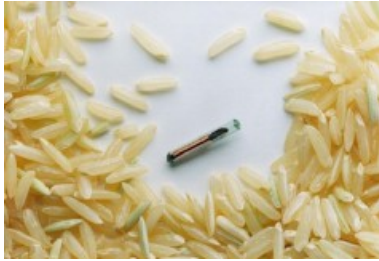
صورة تظهر مقارنة بين أبعاد الرقاقة الحيوية وحببات الرز.
