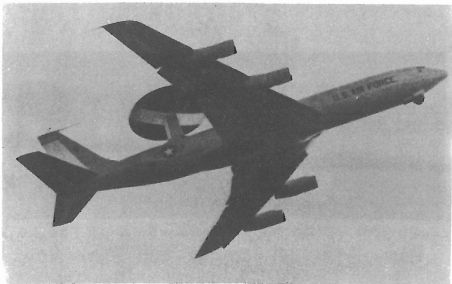
صورة رقم 34 : طائرة إنذار مبكرة أمريكية E-3 Sentry . يلاحظ الرادار الدائري في المؤخرة
