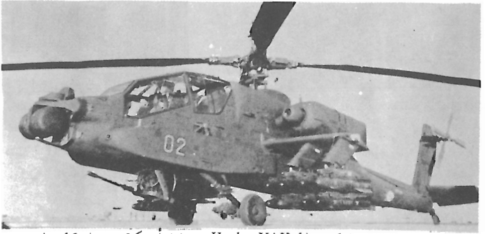
صورة رقم 52 : طائرة هيليكوبتر Hughes YAH-64 (صناعة أمريكية) تحمل 16 صاروخ جو أرض Hellfire
