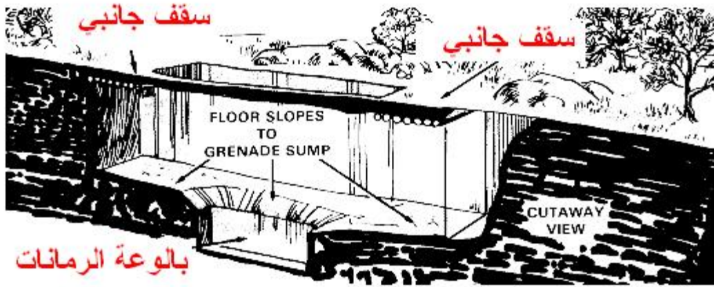
صورة ١٩: الشكل النهائي للخنق ذو الأسقف الجانبية
