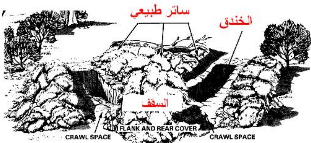
صورة ١٤: الخندق المجهز بشكله النهائي
